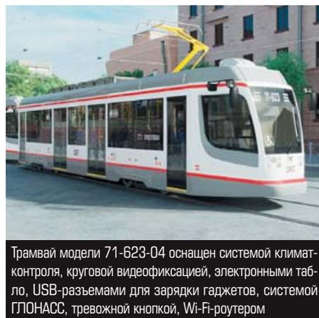
Трамвай модели 71-623-04 оснащен системой климат-контроля, круговой видеофиксацией, электронными табло, USB-разъемами для зарядки гаджетов, системой ГЛОНАСС, тревожной кнопкой, Wi-Fi-роутером
