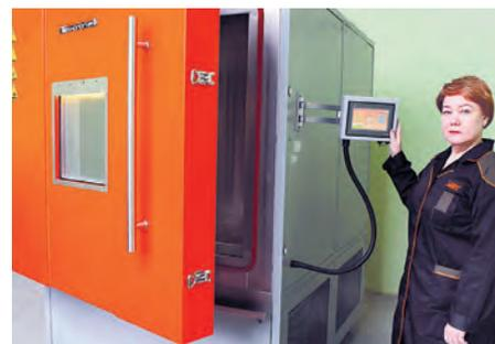
В климатической камере объемом 1000 литров можно проводить испытания различной продолжительности при температуре от  $-700^{\circ}\text{C}$  до  $+1500^{\circ}\text{C}$  и влажности до 98%
