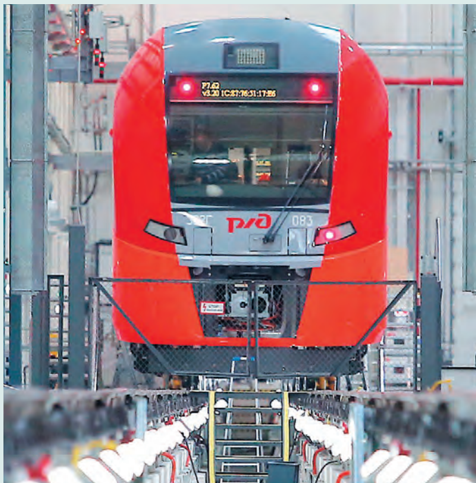
На участке пусконаладки и испытаний производятся финальные операции технологического цикла изготовления «Ласточек». Здесь одновременно может размещаться четыре пятивагонных поезда или два десятивагонных
