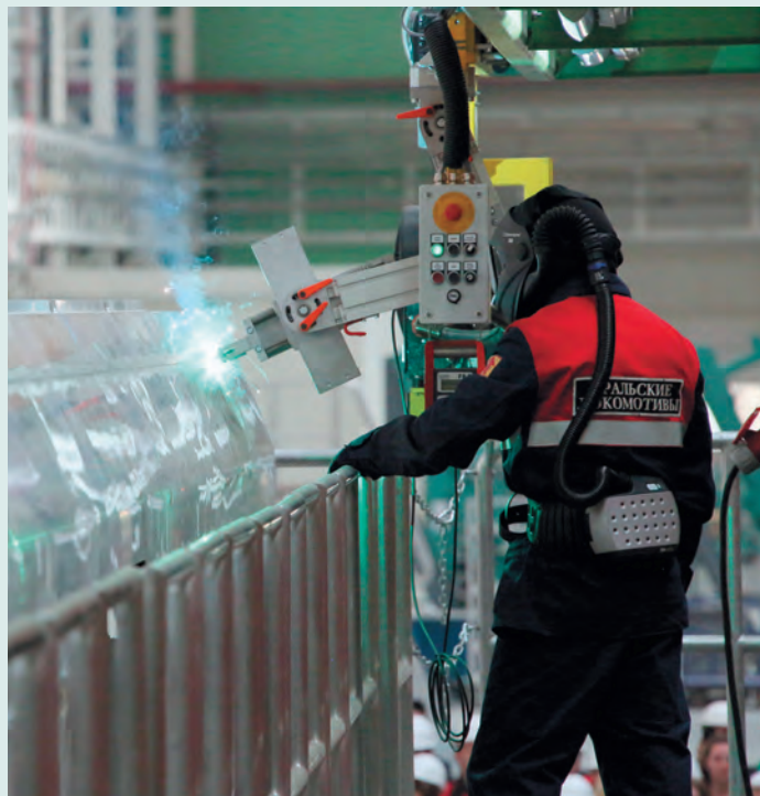
Сварка частей кузова для «Ласточки» осуществляется из алюминиевых профилей на роботизированных автоматических комплексах
