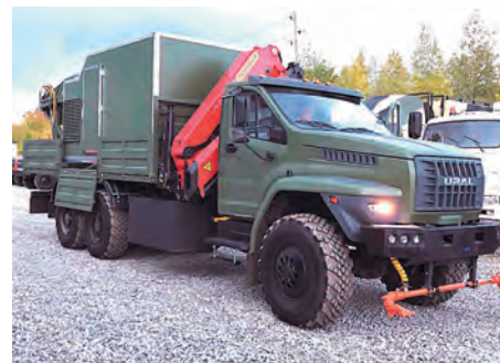
«Урал NEXT» грузоподъемностью 12,5 тонны оснащен мощным рядным двигателем ЯМЗ-53623-10 экологического стандарта «евро-5» мощностью 273 л.с.
