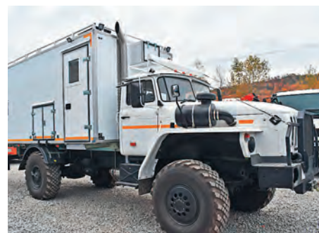
Фургон транспортно-бытовой машины на базе «Урал-М-43206» представляет собой полноценный модуль для проживания в полевых условиях четырех человек
