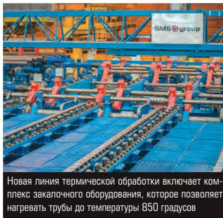
Новая линия термической обработки включает комплекс закалочного оборудования, которое позволяет нагревать трубы до температуры 850 градусов
