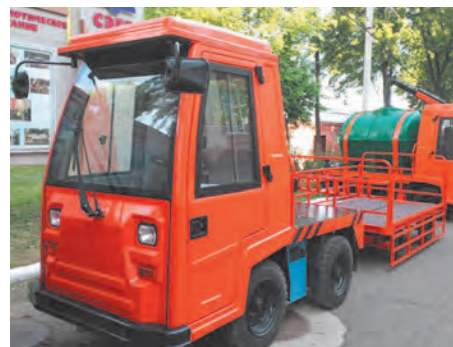
Электротягач из Сарапула оснастили литий-железофосфатной аккумуляторной батареей с длительным сроком службы и большим диапазоном рабочих температур
