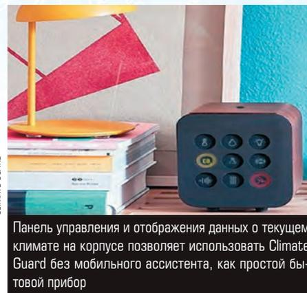
Панель управления и отображения данных о текущем климате на корпусе позволяет использовать Climate Guard без мобильного ассистента, как простой бытовой прибор
