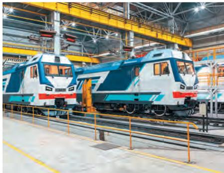
2ЭС7 разработан для обеспечения тяжеловесного движения на железнодорожных линиях переменного тока стран СНГ. Локомотивы могут провозить составы с общей массой до 9 тыс. тонн при максимальной мощности электровоза в 8,8 МВт
