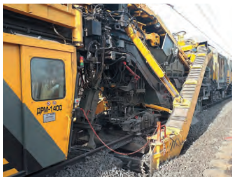
ЩОМ-1400 производства калужского завода «Ремпутьмаш» (входит в состав СТМ) предназначена для очистки щебеночного балласта. Машина состоит из двух секций: добывающе-распределительной и очистной
