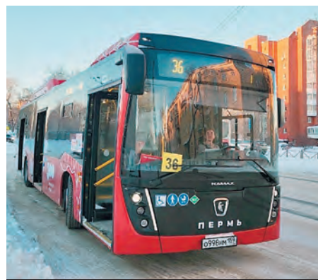
Широкие дверные проемы рестайлингового низкопольного автобуса НефАЗ-5299-40-57 способствуют более быстрой посадке пассажиров в салон, а кузов наклоняется в сторону дверей для удобного входа
