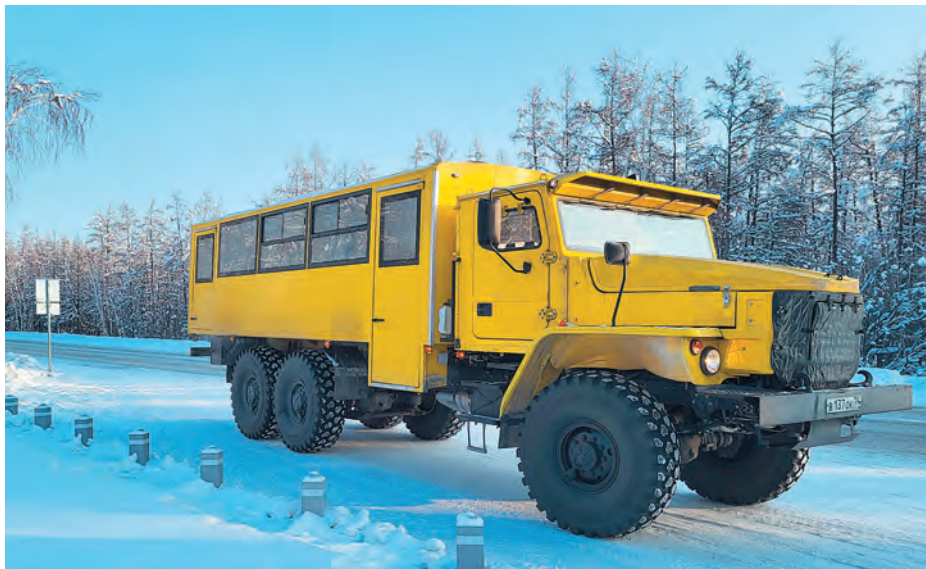
Прошедший в Якутии исследовательские испытания образец арктического автобуса «Урал» предназначен для безопасной и комфортной перевозки людей в условиях экстремальных температур. Модель содержит технические решения (трансмиссионные агрегаты, системы управления и жизнеобеспечения), являющиеся важным вкладом в обретение технологического суверенитета страны
