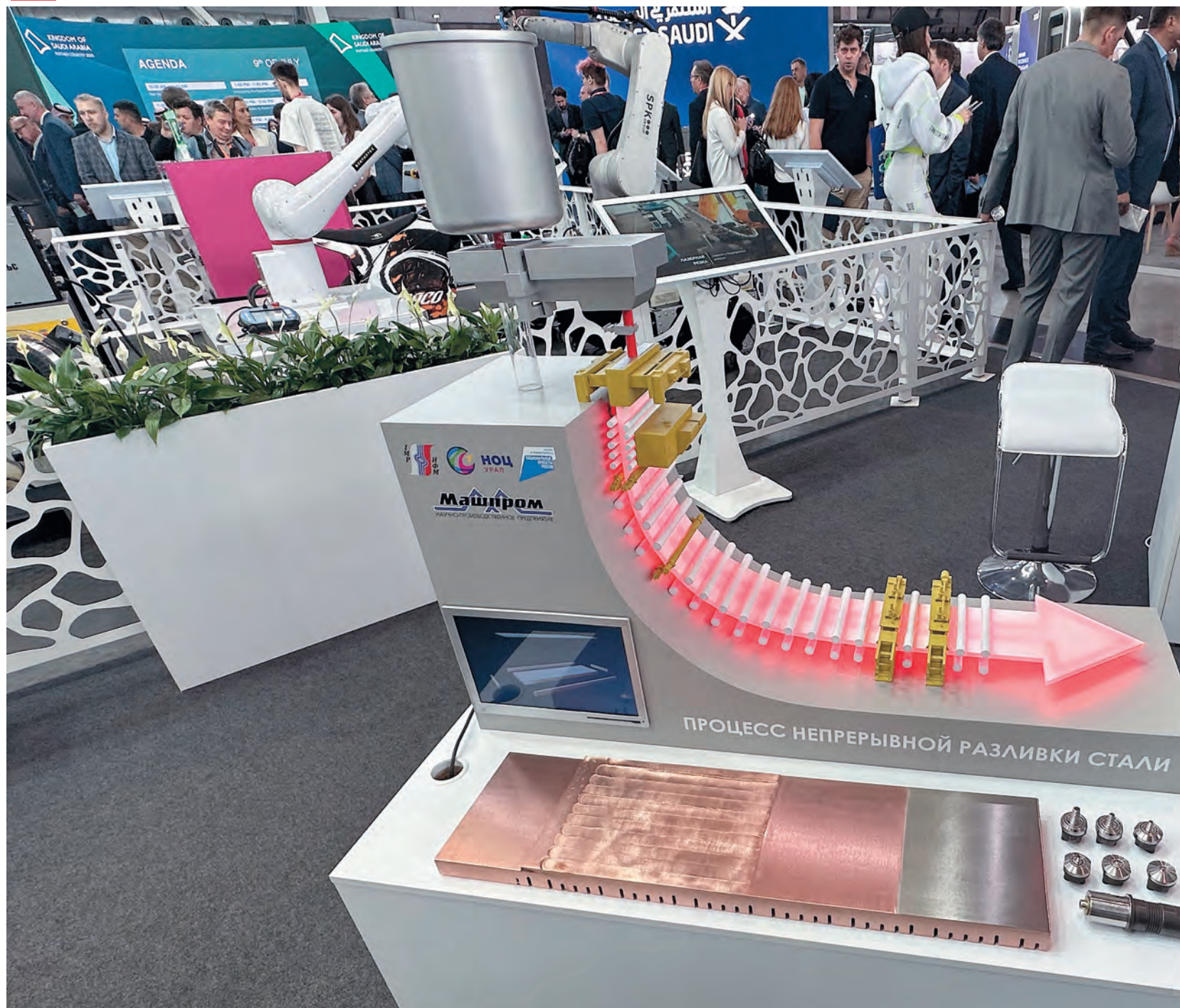
Демонстрация на Иннопроме-2025 технологии восстановления толщины плиты кристаллизатора методом сварки трением с перемешиванием с последующей фрезеровкой и напылением износостойкого композиционного покрытия
