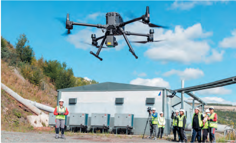
Заместитель главного маркшейдера Даниил Ишмухаметов запускает квадрокоптер, чтобы следить за состоянием бортов угольного разреза
